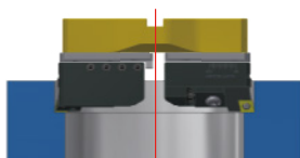
Twin edge boring
